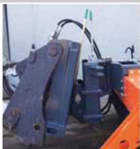
Rulleskakt med højdejusteringsanvisning og penduladapter
