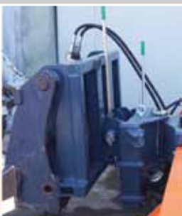
Rulleskakt med højdejusteringsanvisning og penduladapter
