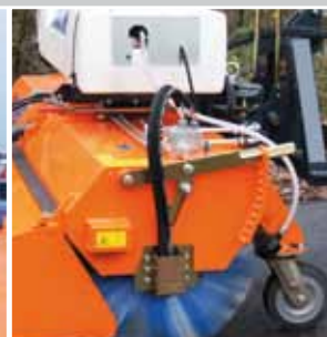
Højde justeringsanordning med børste optimering
