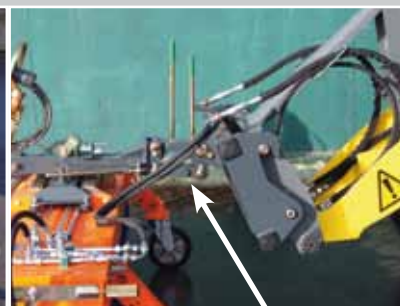
Mini-/front-læsser med parallellogram og penduludligning incl. højdeangivelse
