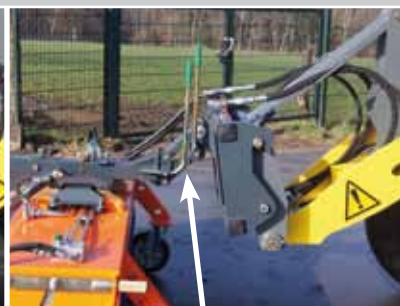
Mini-/front-læsser med parallellogram og penduludligning incl. højdeangivelse
