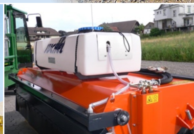
Wassersprüheinrichtung mit 100/200 Liter Wassertank
